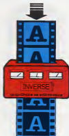
El efecto de INVERSE 1 en la pantalla es similar a la acción de un negativo fotográfico.
